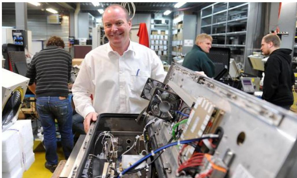
Georg Stirnimann zeigt, wie die Kästen (Repeater) im Tunnel für das Funksystem GSM-Railways aussehen.
